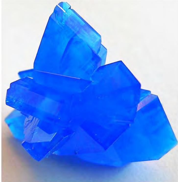
Cristales de sulfato de cobre (II). Estos cristales tienen una estructura cristalina triclínica.
