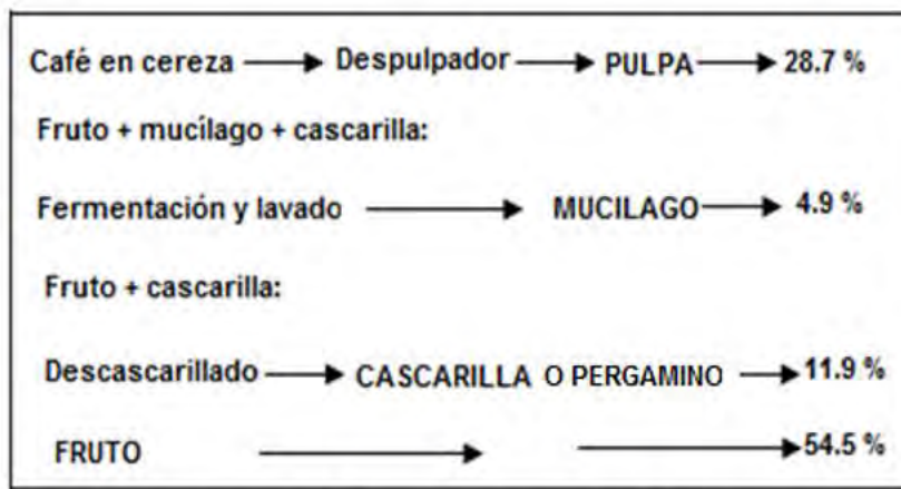
Figura 3. Balance de materiales en el procesamiento del fruto del café Fuente: (3).
